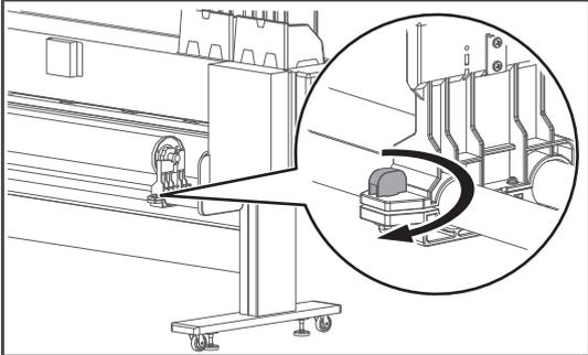
ロール紙受け（右）のノブボルトを時計回りに回転させて、締めます。
