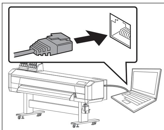
[5] プリンターの操作パネルで、IP アドレス、サブネットマスク、ゲートウェイを設定します。
