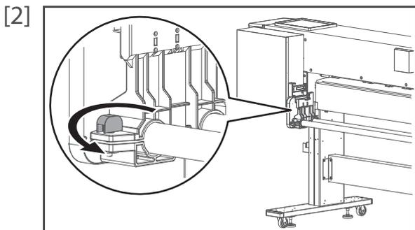
ロール紙受け（左）のノブボルトを反時計回りに回転させて、緩めます。
