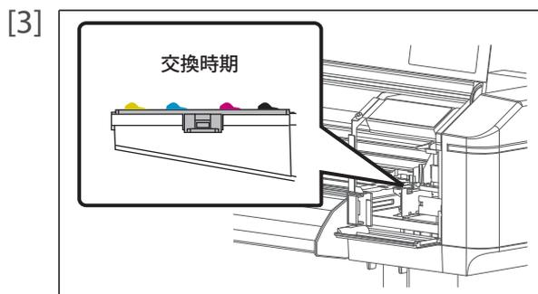
フラッシングボックス用吸収材を確認します。
