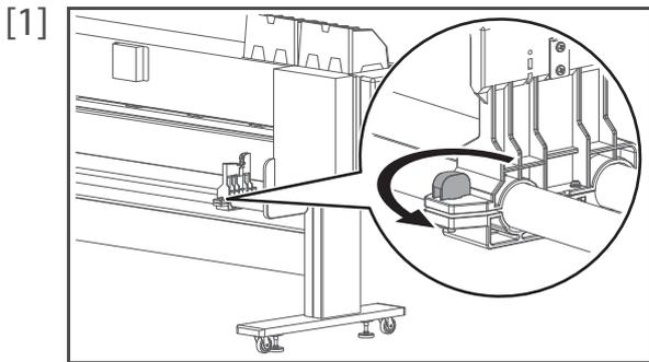
ロール紙受け（右）のノブボルトを反時計回りに回転させて、緩めます。
