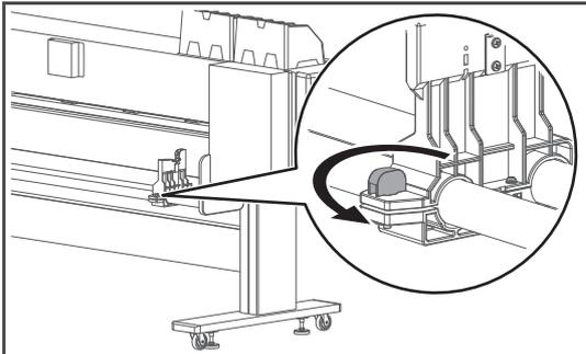
ロール紙受け（右）のノブボルトを反時計回りに回転させて、緩めます。
