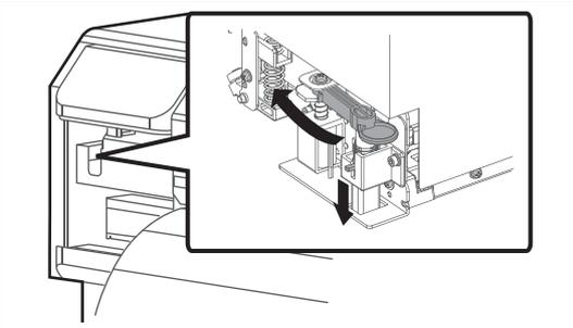
カッターのつまみを軽く押しながら、カッターキャップを図の方向に回転させます。
