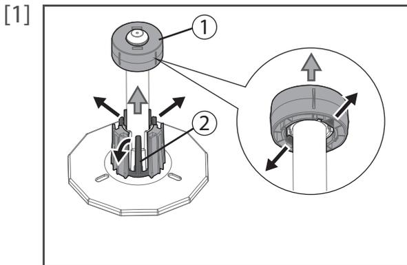
(内径が2インチのメディアを使用する場合のみ) フランジから3インチアダプターを取り外します。
