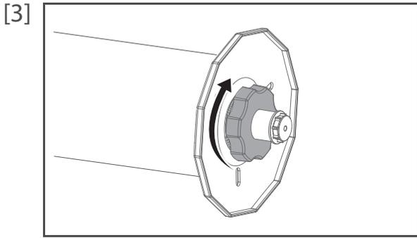
フランジのハンドルを時計回りに回転させて、フランジを固定します。
