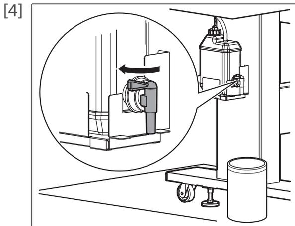
廃液を空容器に移し終わったら、廃液コックを確実に閉めます。
