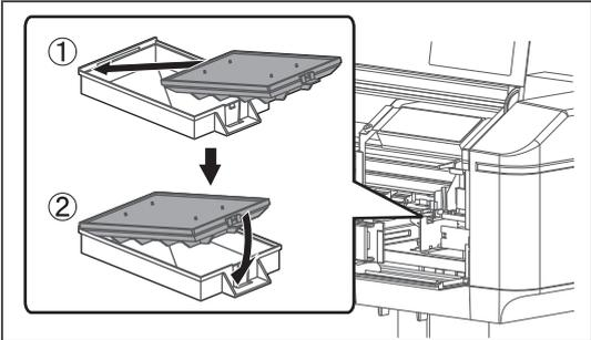
新しいフラッシングボックス用吸収材を取り付けます。
