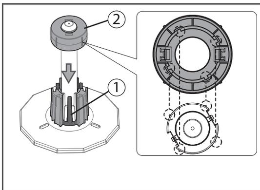
(内径が2インチのメディアから3インチのメディアに変更して使用する場合) フランジに3インチアダプターを取り付けます。
