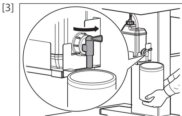
廃液コックを開き、空容器に廃液を移します。
