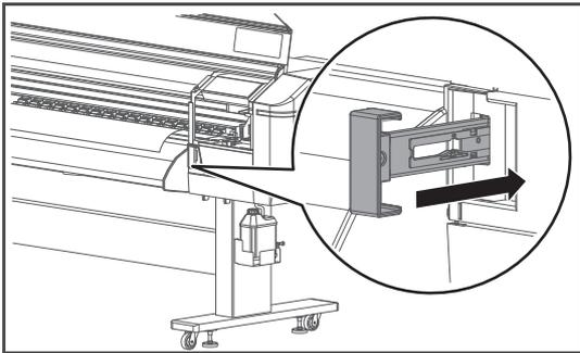
(スライドロックレバーをキャンセルにする場合) メディアセットレバーを元の状態に戻して、加圧アームを下げます。
