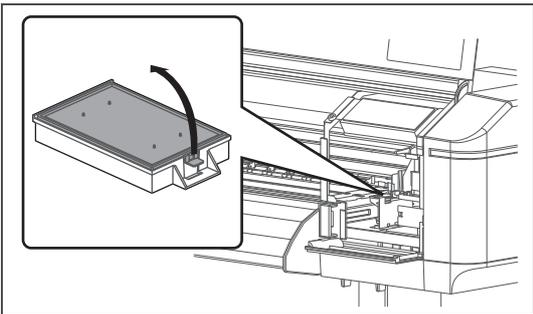
フラッシングボックス用吸収材のツメ部を持ち上げてフックを解除し、フラッシングボックス用吸収材を取り外します。
