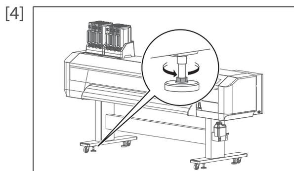
専用スタンドのアジャスター（4箇所）を、左図の方向に回転させて緩めます。
